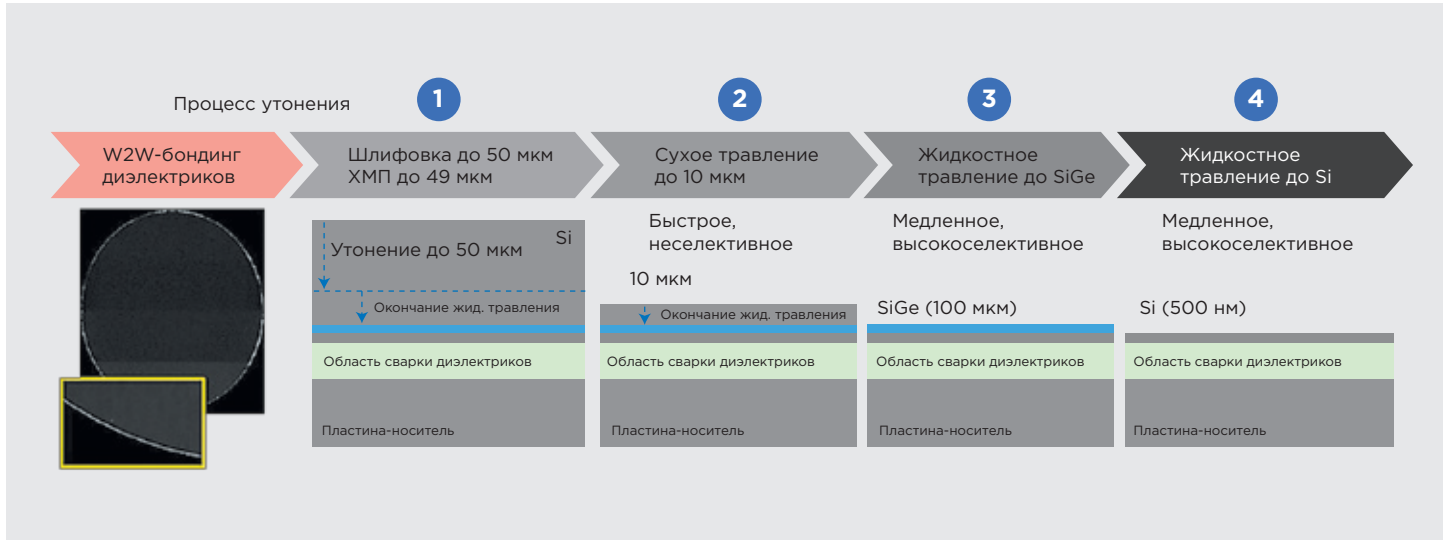
2 Процесс экстремального утонения до 500 нм после бондинга W2W. Источник: Chip Scale Review January, February, 2021, Extreme Si thinning and nano-TSVs to advance 3D heterogeneous integration By Dave Thomas and Anne Jourdain
